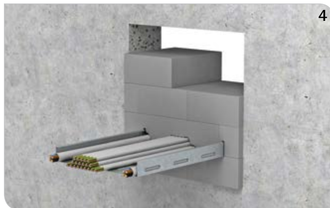
Brandschutzkitt um die Kabel in der Öffnung auf einer Länge von mindestens 10 cm auftragen und weitere BIS Pacifyre® IWS Brandschutzsteine auflegen.
