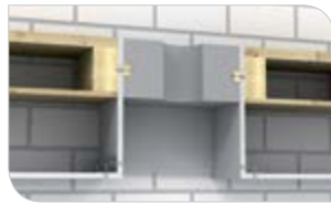
Holzbalkendecke mit Unterdecke
