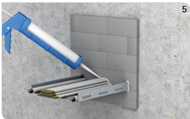
Nach dem Einbringen der BIS Pacifyre® IWS Brandschutzsteine, Restspalte mit Brandschutzkitt verschließen.
