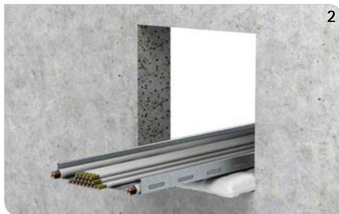
Nach Möglichkeit die erste Lage BIS Pacifyre® IWC Brandschutzkissen unter die Kabeltritsche oder das Kabelbündel platzieren.
