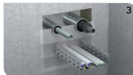
3 Verlorene Schalung mit Klebeband erstellen.
