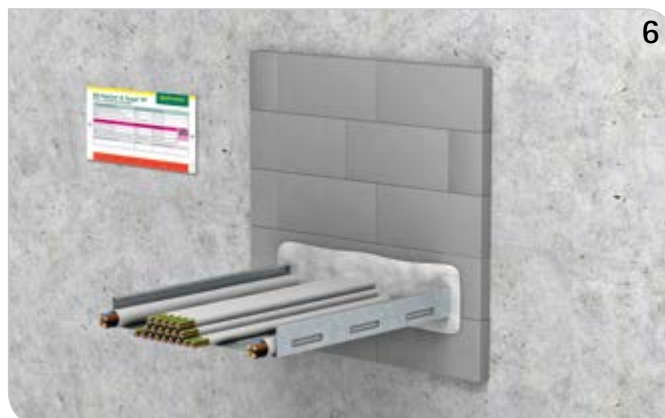
Schott auf Richtigkeit prüfen, Kennzeichnungsschild ausfüllen und neben der Abschottung anbringen.
