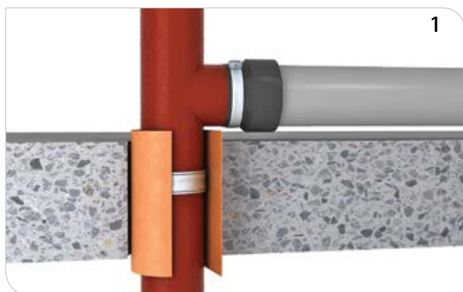
BIS Pacifyre® SML Flex Brandschutzmatte einlagig um das Rohr legen, in das Bauteil schieben und andrücken.
