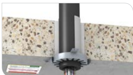
Pythonleitungen (Getränkeleitungen) ggf. mit Schutzrohr
