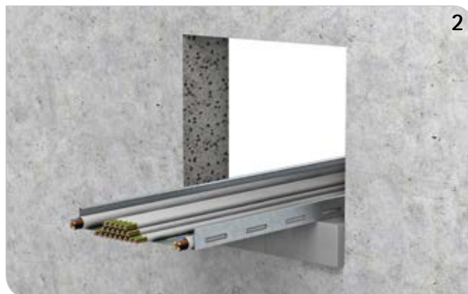
BIS Pacifyre® IWS Brandschutzsteine mit der langen Seite (160 mm) nach vorne in die Öffnung einbringen.
