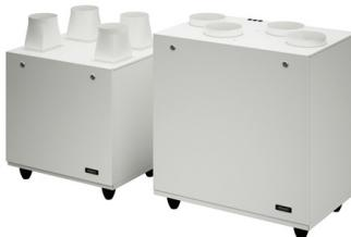
Naprava RePuro vsebuje inovativen sistem za vračanje toplotne, ki dosega temperaturne izkoristke do 90%. Izjemno visoki izkoristki protitočnega prenosnika omogočajo velike prihranke energije, saj je temperatura vtočnega zraka le za malenkost nižja od temperature odtočnega zraka, kar pomeni da je vložek energije potrebne za dogorevanje svežega zraka majhen. Cena ne vsebuje zagona.
