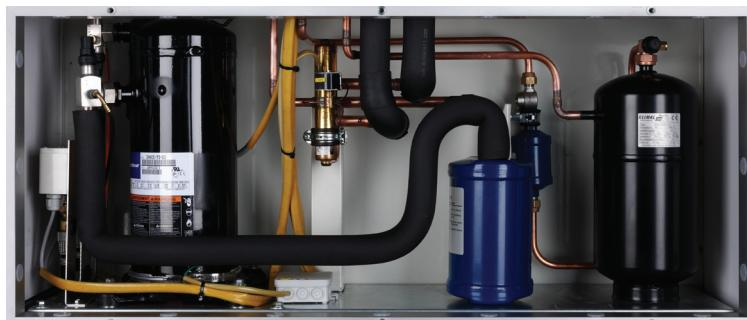
Hladilni krog izvedbe BASIC vključuje vse potrebne komponente vključno z uparjalnikom (hlajenje) in kondenzatorjem (ogrevanje). Vse kontrolne komponente so nameščene v hladilnem krogotoku. Tlačno zaznavalo se uporablja za krmiljenje sistema, tlačno stikalo pa za varno zaustavitev sistema. V Basic izvedbi je nameščen en kompressor, ki je preračunan v skladu z izračunano hladilno zmogljivostjo. Euroclima uporablja le visokokakovostne materiale in komponente kot so Copeland, Danfoss, Alco, itd.
